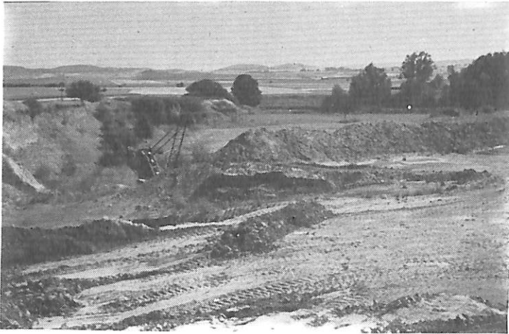
Abb. 29 Der Lehm wird hier in der riesenhaft ausgebreiteten Grube abgebaut und mit Rollwagen zur Ziegelei gebracht.
