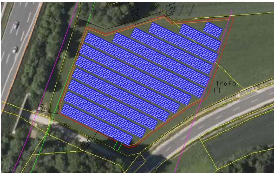
Abbildung 7: Belegungsplanentwurf der Photovoltaikanlage
